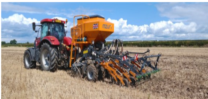
Billede 18. Mzuri Pro-Til strip-till såmaskinen grubber, pakker og sår med tænder udstyret med individuelle dybdestyringshjul. Foto: Mzuri
