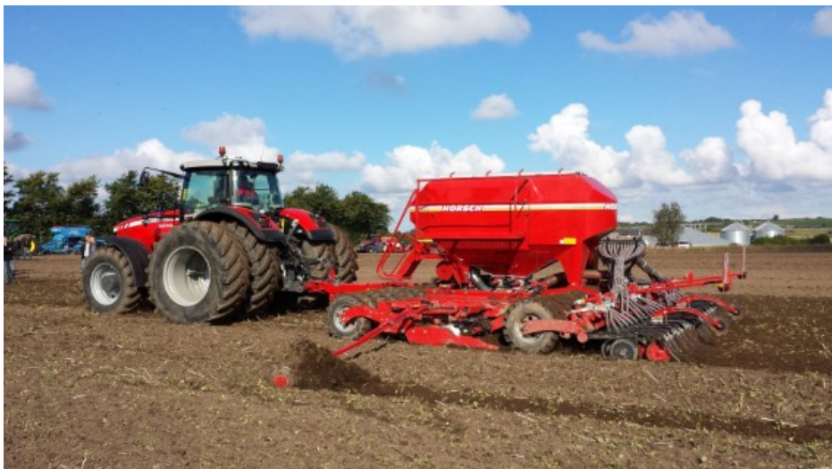
Billede 6. Horsch Pronto har en pakvalse både forrest og bagerst. Foto: Henning Sjørnslev Lyngvig
