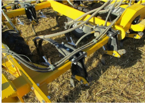
Billede 15. Forrest en smal harvetand efterfulgt af såskæret. Foto: Henning Sjørsløv Lyngvig
