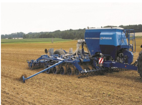
Billede 16. Köckerling Ultima tandskærssåmaskinen monteret med STS pakvalse. Foto: Köckerling
