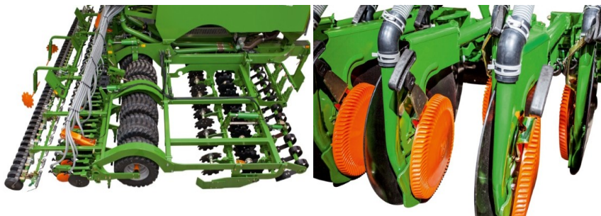
Billede 4. Jordbearbejdning foretages med tallerkner efterfulgt af pakning. Foto: Amazone
